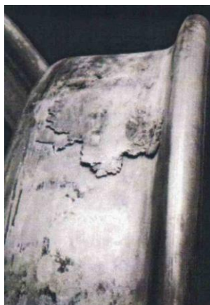
Фиг.13. Образуване на плоски места със завличане на материал
