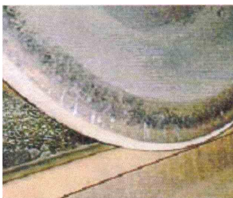
Фиг. 17. Образуване на радиални пукнатини на повърхността на търкаляне
