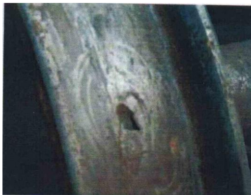
Фиг. 14. Откъртвания на метал, образуване на дупки и язви по повърхността на търкаляне
