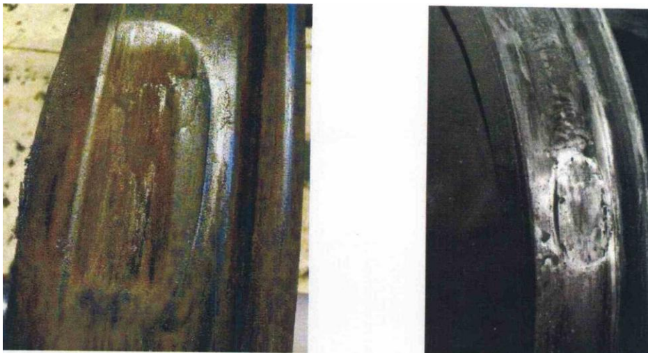
Фиг. 12. Образуване на плоски места
